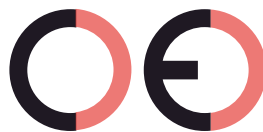
Falsche CE-Kennzeichnung (zu großer Zwischenraum)
