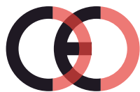
Falsche CE-Kennzeichnung (zu dicht)
